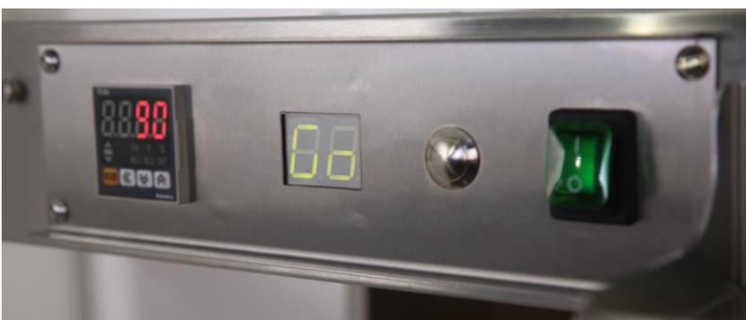
Электронный терморегулятор от 30С до 90С для индикации текущей температуры и таймер с кнопкой сброса для контроля срока хранения картофеля (только для модели RLFSL-IR6)
