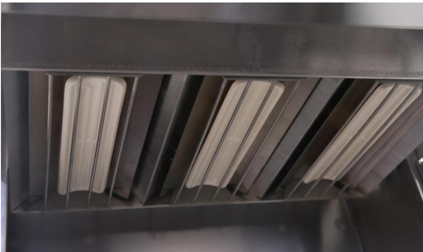
Поддержания картофеля в теплом состоянии осуществляется при помощи керамических нагревающих элементов сверху и подогрева ванны снизу.
